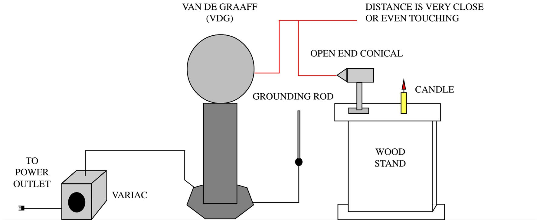
WHEN VDG IS IN OPERATION FLAME IS BLOWN
